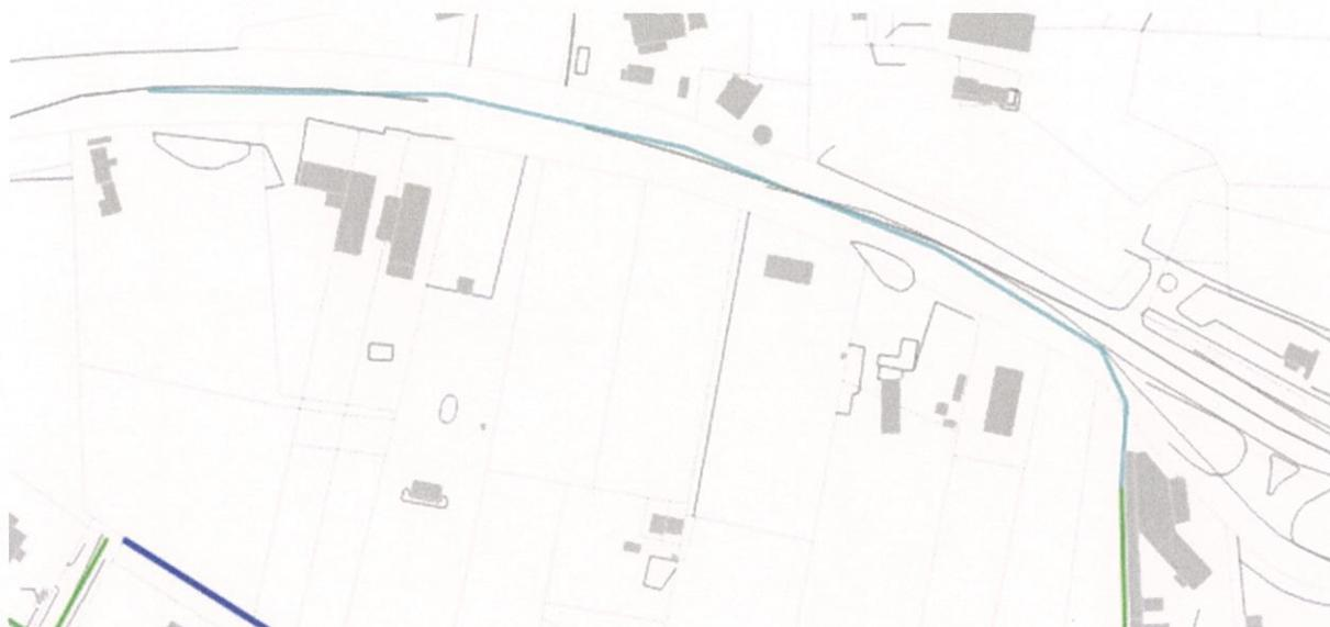
Les travaux consistent à créer 440 ml de réseau gravitaire à raccorder sur le réseau existant à l'Est.
