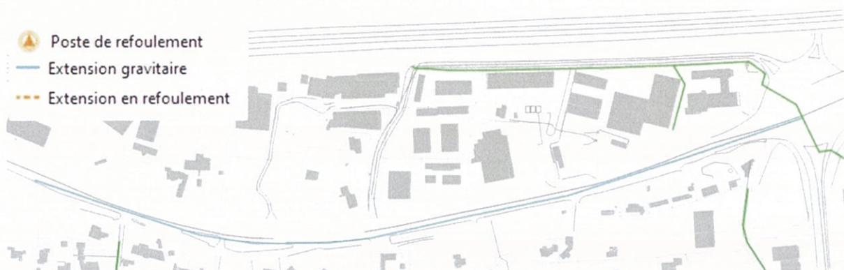
Ce scénario consiste à créer 870 ml de réseau gravitaire le long de la RDN7.
